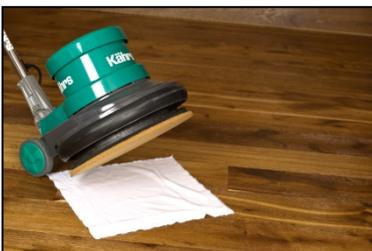
Gleich anschliessend (max. 30 Minuten, je nach Raumklima) kann die Holzoberfläche mit einem trockenen, fuselfreien Baumwolltuch nachpoliert werden.
