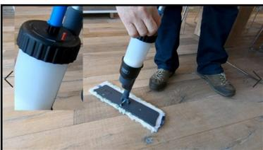
Druck des Behälters mit Betätigung des roten Knopfs lösen. Druckflasche entfernen und für den nächsten Einsatz aufbewahren.
