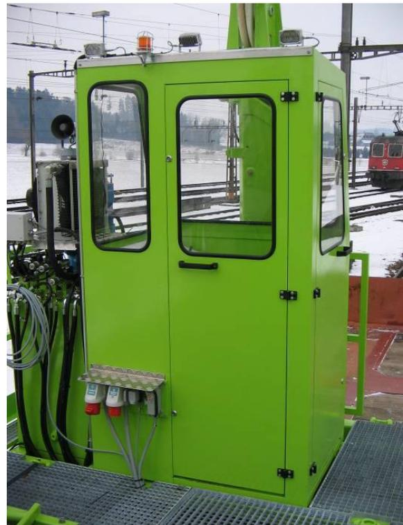
Bild 4 Bedienstand, Hydraulikaggregat
