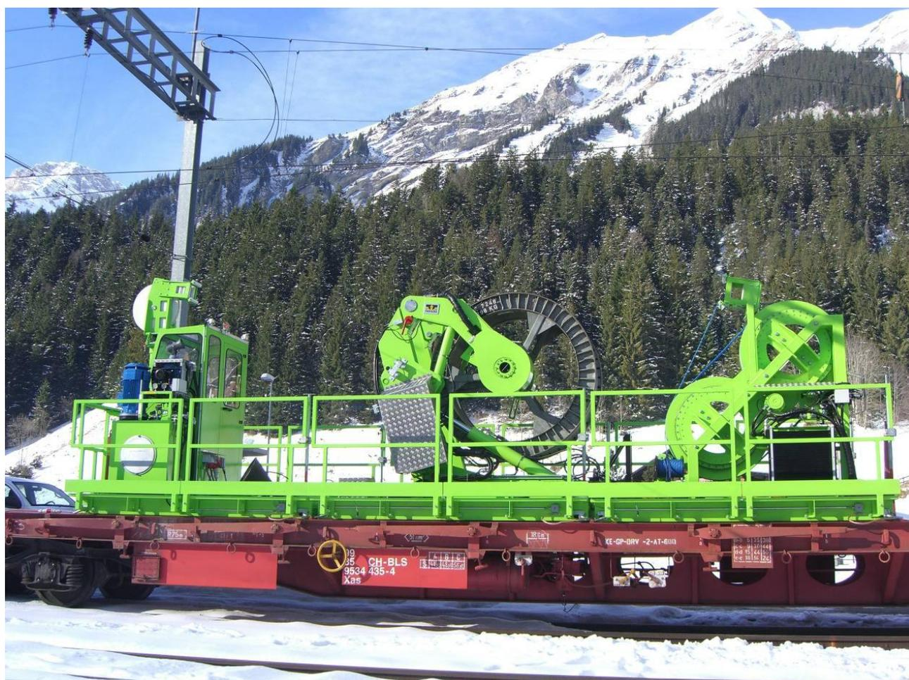
Bild 1 Nencki-Kabelabrollbock mit Bedienstand und Spill (Module 1-3)
