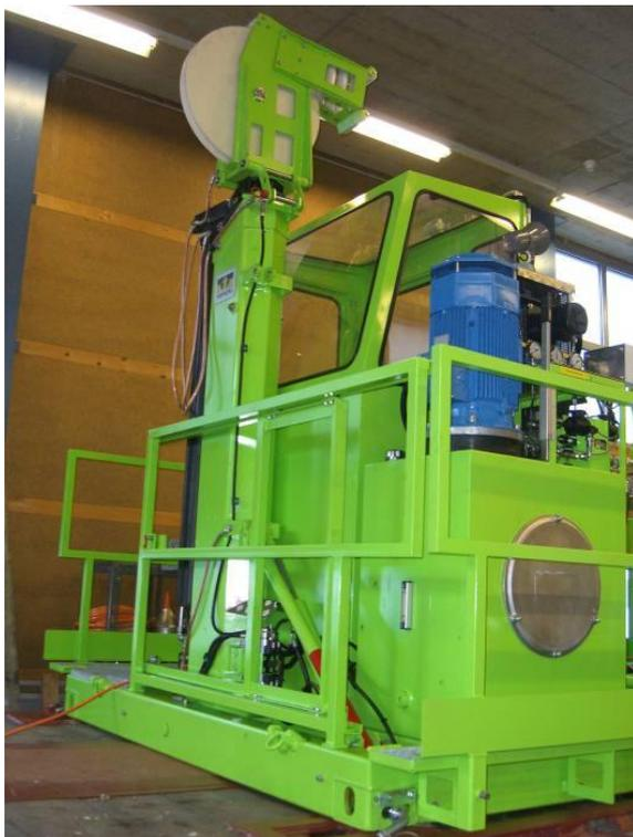
Bild 3 Drückerarm, Hydraulikaggregat
