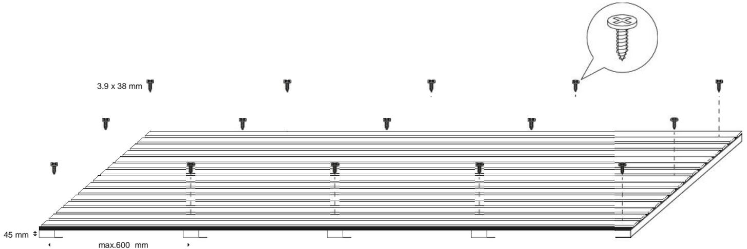
1. Installieren Sie die Unterkonstruktion (UK) quer zur Laufrichtung der Lamellen des Akustik-Paneels an Wand oder Decke, im Idealfall dämmen Sie den Bereich zwischen der UK um die Schallabsorption zu erhöhen.
