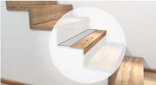
Trittstufen werden mit Bodendielen ausgeführt
