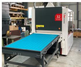
Unsere Rotations-Bürstmaschine TimeSaver 32 RB eignet sich für das Entgraten, Kantenverrunden, Finishschleifen, Oxidschichtentfernung und Schlackenentfernung von verschiedenen Materialien.
