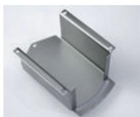
Unsere CNC-Abkantpressen mit einer maximalen Presskraft von 320 Tonnen und unsere Rundbiegemaschine sind speziell für eine individuelle Auftragsbearbeitung ausgelegt.
