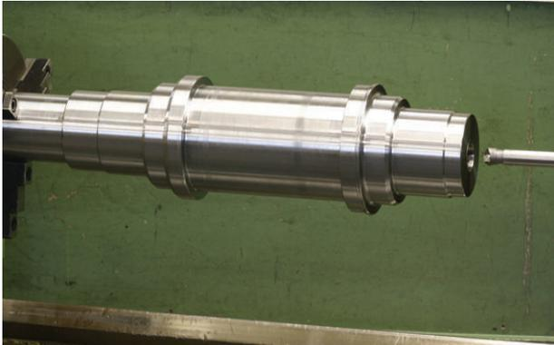
Auf unserer Tieflochbohrmaschine können wir Vollbohren, Kernbohren und Aufbohren. Die Bohrung muss zentrisch im Werkstück sein. Das maximale Stückgewicht beträgt 2t. Wir bohren (vorhandenes Werkzeug vorausgesetzt) alle Innendurchmesser zwischen  $\varnothing$  25mm und  $\varnothing$  170mm. Die Tieflochbohrmaschine bohrt 0.05-0.1 mm Rundlauf pro 100mm Bohrtiefe bei mittig gebohrten, rotationssymmetrischen Bauteilen im gegenläufigen Bohrverfahren.
